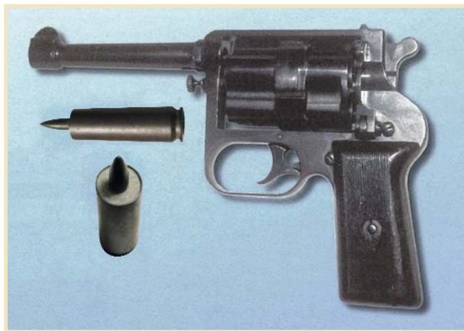
Способ Бизела: 1. Ствол; 2. Патрон; 3. Патронник; 4. Поршень; 5. Пуля; 6. Жидкость
