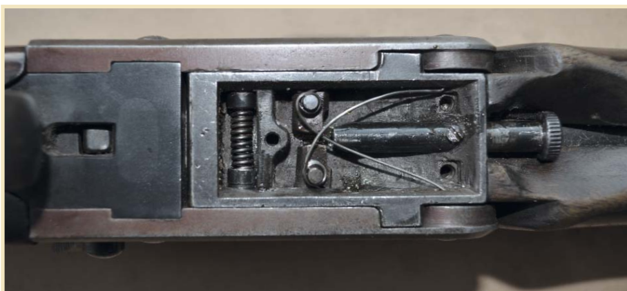
Ружьё ГЕЦ-9: механизм ограничителя открывания
